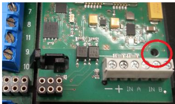
Rys.5 Miejsce przykręcenia śrubki (w razie występowania problemu z przekrzywieniem modułu)
