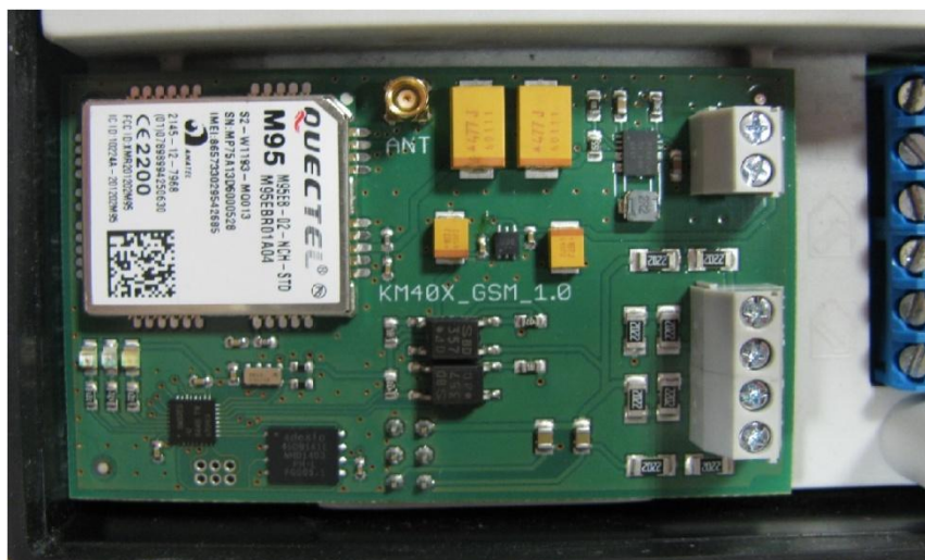
Rys.2 Zamontowanie płytki w liczniku Kamstrup 401
